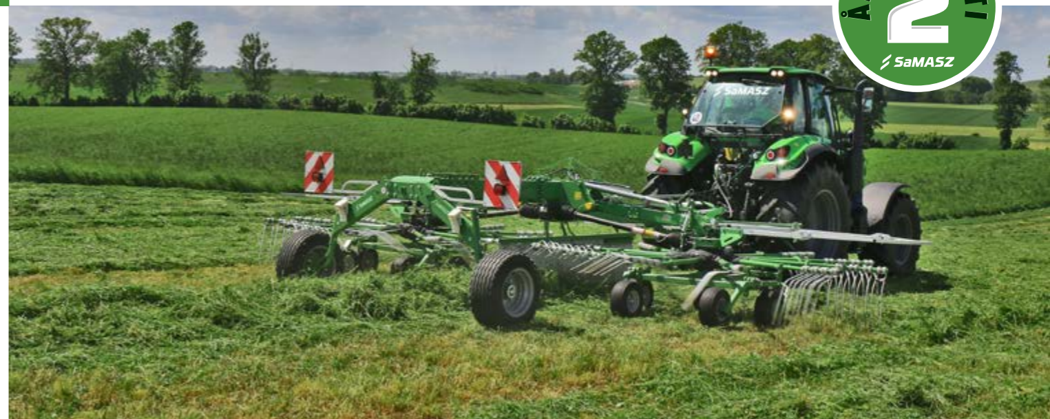
Fig. A. Variabel arbejdsbredde inden for 7,20 og 7,60 m, Z2-840 (7,60 - 8,40) område. Justering er kun mulig i transportposition ved at indsætte en stift.
